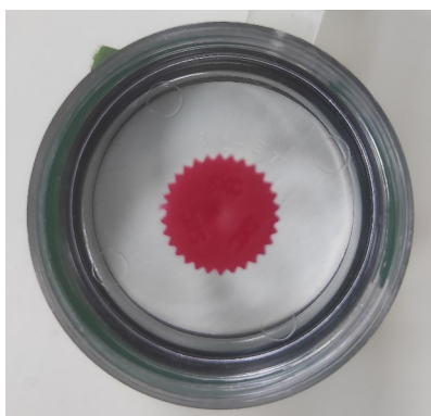
Ilustracja 1: Kasetka SKC - widok na INLET
