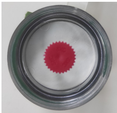
Ilustracja 1: Kasetka SKC - widok na INLET
